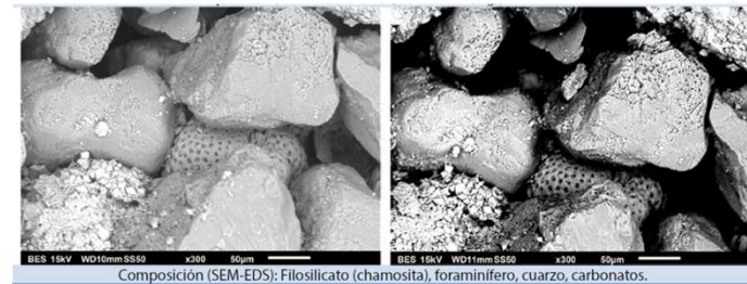
Composición (SEM-EDS): Filossilicato (chamosita), foraminifero, cuarzo, carbonatos.
